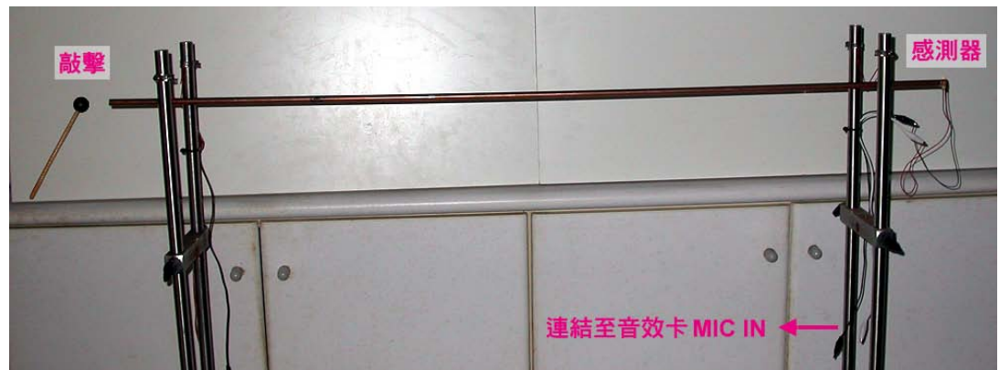
圖 6 感測器聲波波形記錄測試裝置
