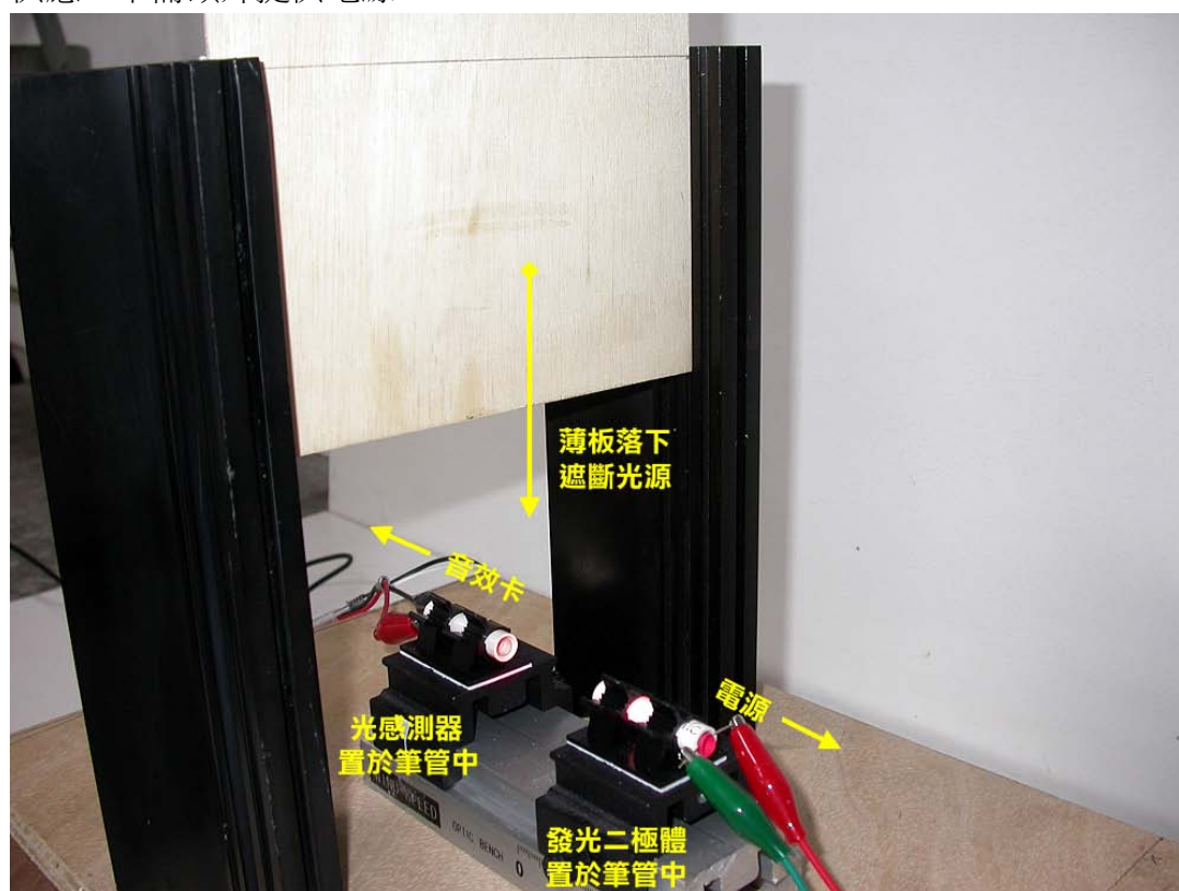
圖 9 光感測器的選取測試
