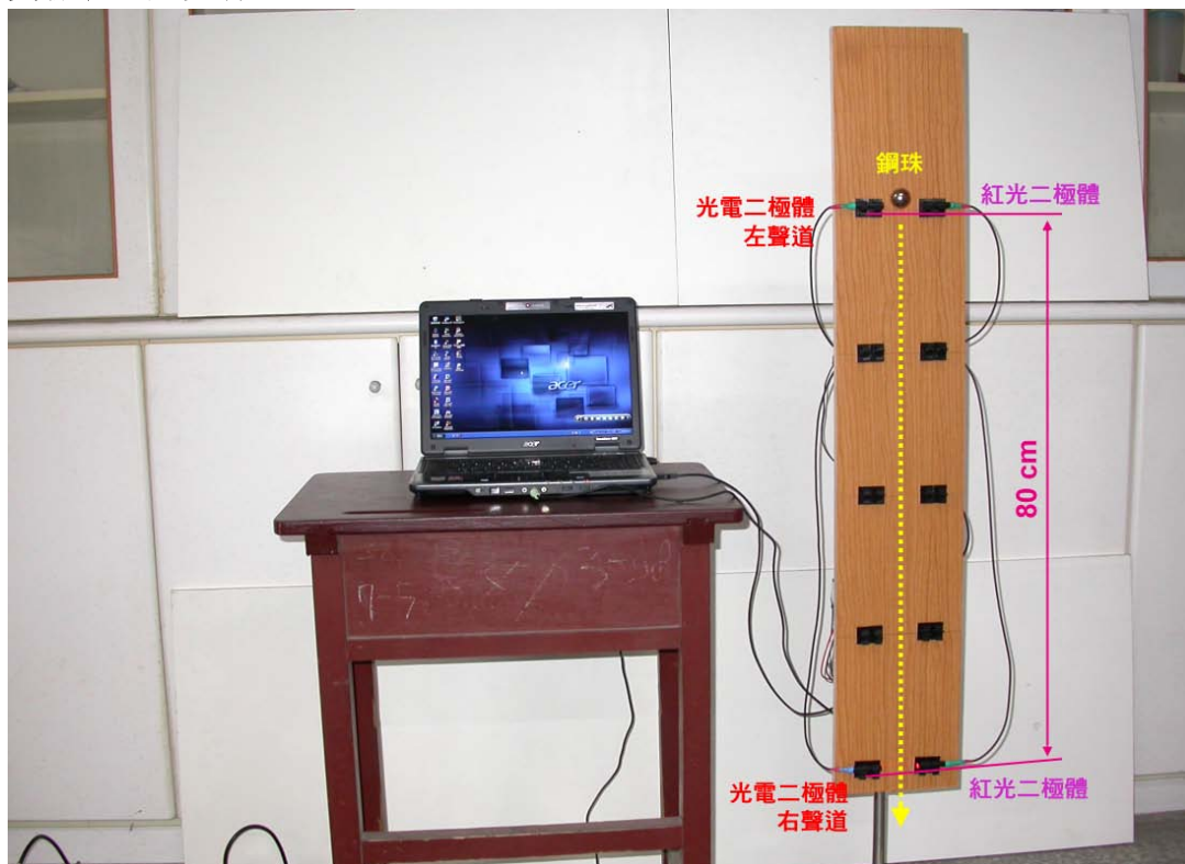
圖 15 自由落體加速度測量裝置圖
