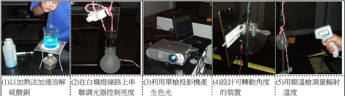
(4) 在進行〈實驗三〉探討照光角度與光電流之關係中，為了能準確的控制太陽能板的傾斜角度，我們在太陽能板背面沿水平中心線上黏貼一細吸管，穿過固定於鐵架上的竹籤後便能任意的轉動角度，另外在竹籤的鉛直線上將量角器對準並以膠帶固定，即可直接觀察角度，方便操作且提升準確度。
