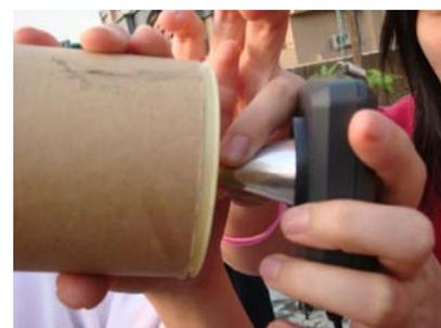
以錐形光罩量測光纖照度
