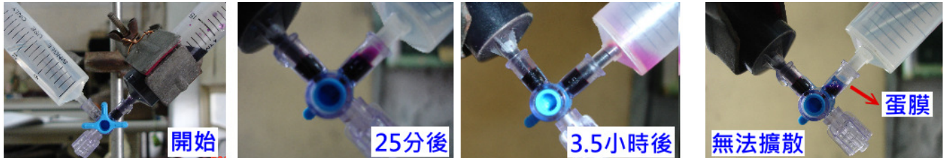
一開始的實驗：過錳酸鉀在管徑中的擴散-向右上方的擴散很慢
