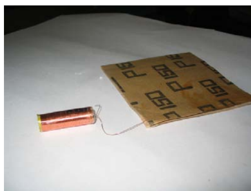
圖【二-6】 用砂紙磨掉末端的漆，再用三用電表歐姆檔測試是否正常
