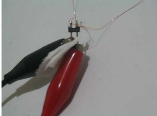
圖【八-2】鱷魚夾易接觸的地方用絕緣體隔開，確保不會短路
