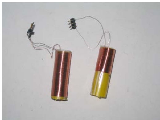
圖【七_1_1】不同粗細的線圈 （左是線徑 0.30mm 右是線徑 0.15mm 的線圈）
