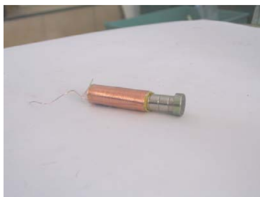
圖【二-9】將線圈套在磁鐵的外緣
