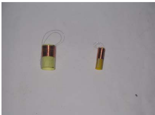
圖【七_3_1】不同直徑的線圈 (左是直徑 2.30cm，右是直徑 1.14cm)
