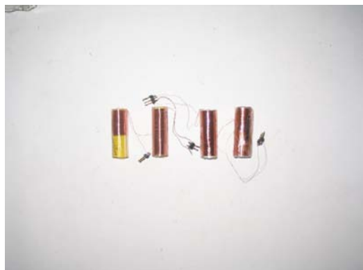
圖【七_2_1】不同線圈數的線圈 （由左而右為 150、300、600、1200 圈）。
