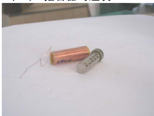
圖【二-8】疊成柱狀的磁鐵與線圈
