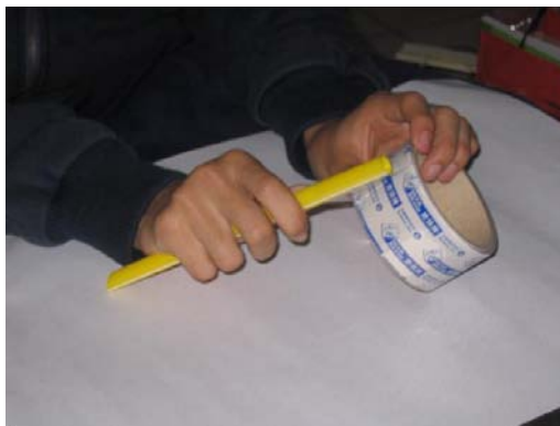
圖【二-2】 先將吸管外反貼一圈膠帶，以利漆包線固定
