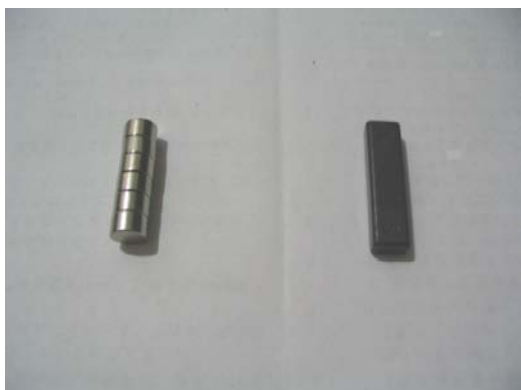
圖【六-1】不同磁力的磁鐵 （左是六顆釹鐵硼磁鐵吸成柱狀，右是普通矩形磁鐵）
