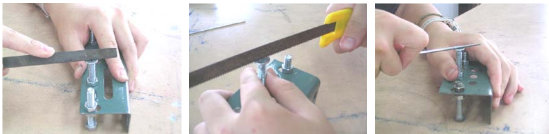
圖【五-1】【五-2】【五-3】磨製有刻「V」字型溝槽的特殊琴鈕。
