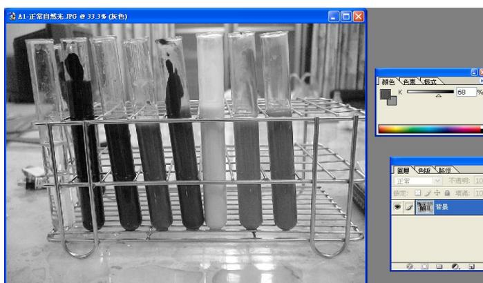
※左圖為 Photoshop 軟體利用灰階模式轉換，透過色彩選取方式，可由右上角的灰階強度比例圖來了解該點的灰階強度，圖例是上圖透過灰階後，分析紅色部分的灰階強度為 68，也就是反射強度為 32。
