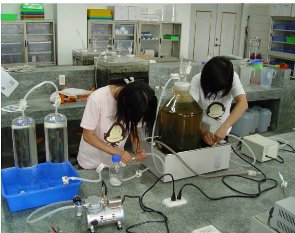
圖 9. 裝置厭氣發酵槽及沼氣收集瓶
