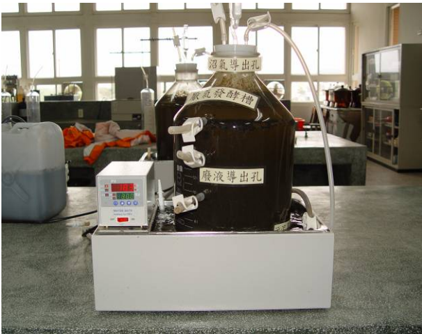
圖 7. 厭氣發酵槽置於恆溫水浴槽中
