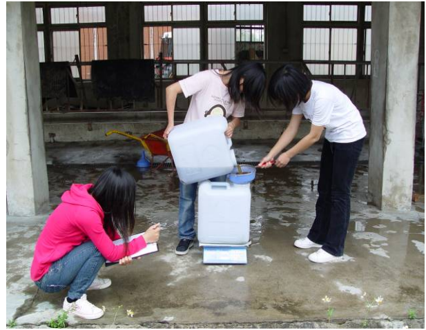
圖 6. 用濾網將固形物濾出
