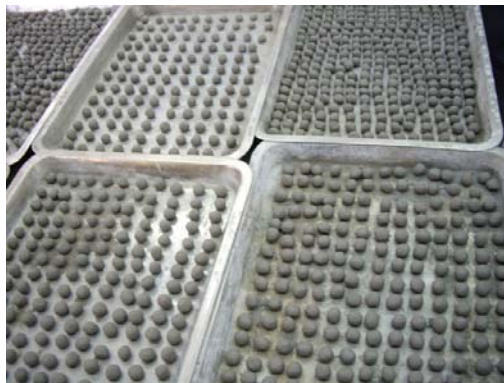
圖 4-7 石材廢泥造粒成品
