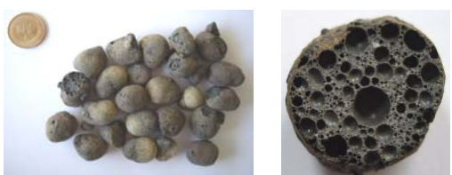
圖 5-28 B1100-15 輕質粒料外觀及剖面
