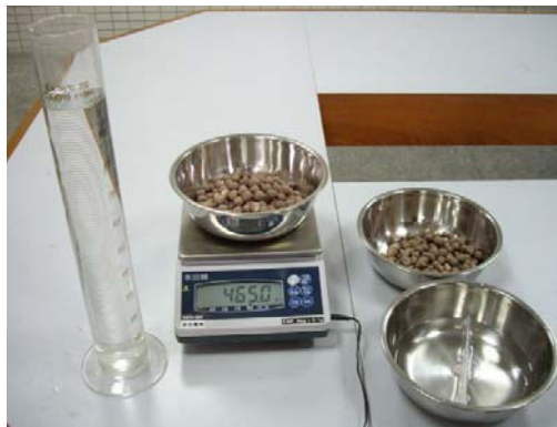
圖 4-9 比重試驗過程
