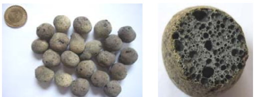
圖 5-27 B1100-5 輕質粒料外觀及剖面
