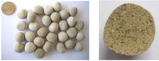
圖 5-23 B1050-5 輕質粒料外觀及剖面
