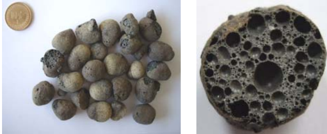
圖 5-28 B1100-15 輕質粒料外觀及剖面
