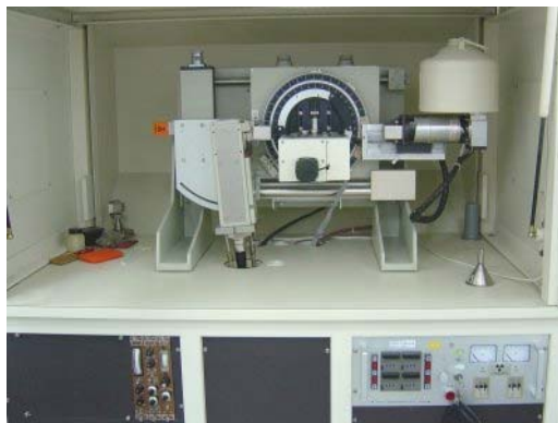
圖 3-4 X-Ray 繞射分析儀 (XRD, Scintag PAD 5V)
