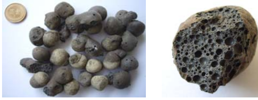
圖 5-29 B1125-5 輕質粒料外觀及剖面
