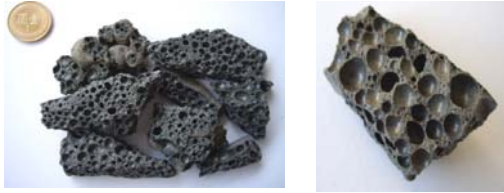
圖 5-30 B1125-15 輕質粒料外觀及剖面
