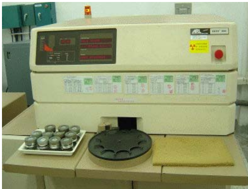
圖 3-3 X-Ray 螢光分析儀 (XRF, Thermo ARL 8680)
