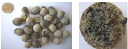
圖 5-26 B1075-15 輕質粒料外觀及剖面
