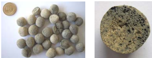
圖 5-25 B1075-5 輕質粒料外觀及剖面
