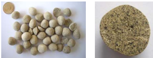
圖 5-24 B1050-15 輕質粒料外觀及剖面
