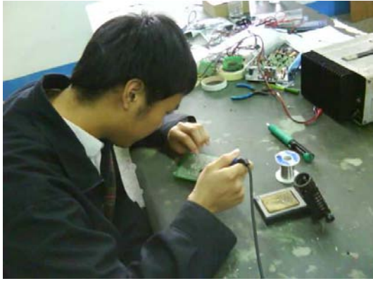
焊接成電路板
