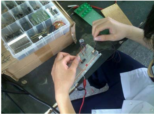
以麵包板製作電路
