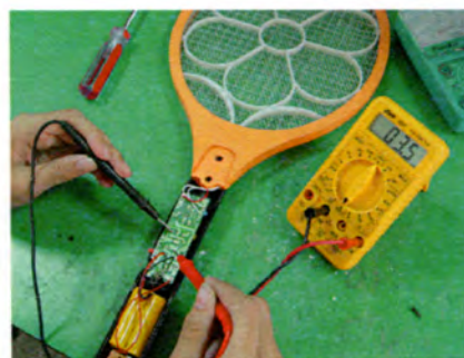
圖 2 測試電蚊拍耗電流量
