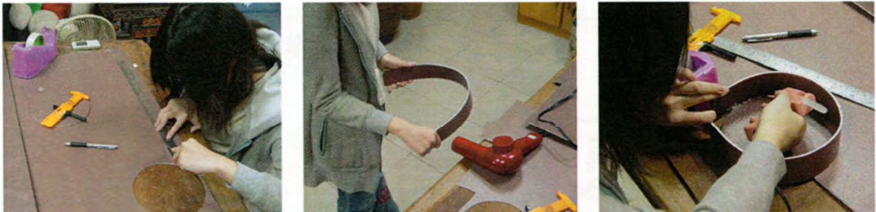
圖 19 材料裁切所需尺寸後，利用吹風機熱風軟化折成圓形狀
