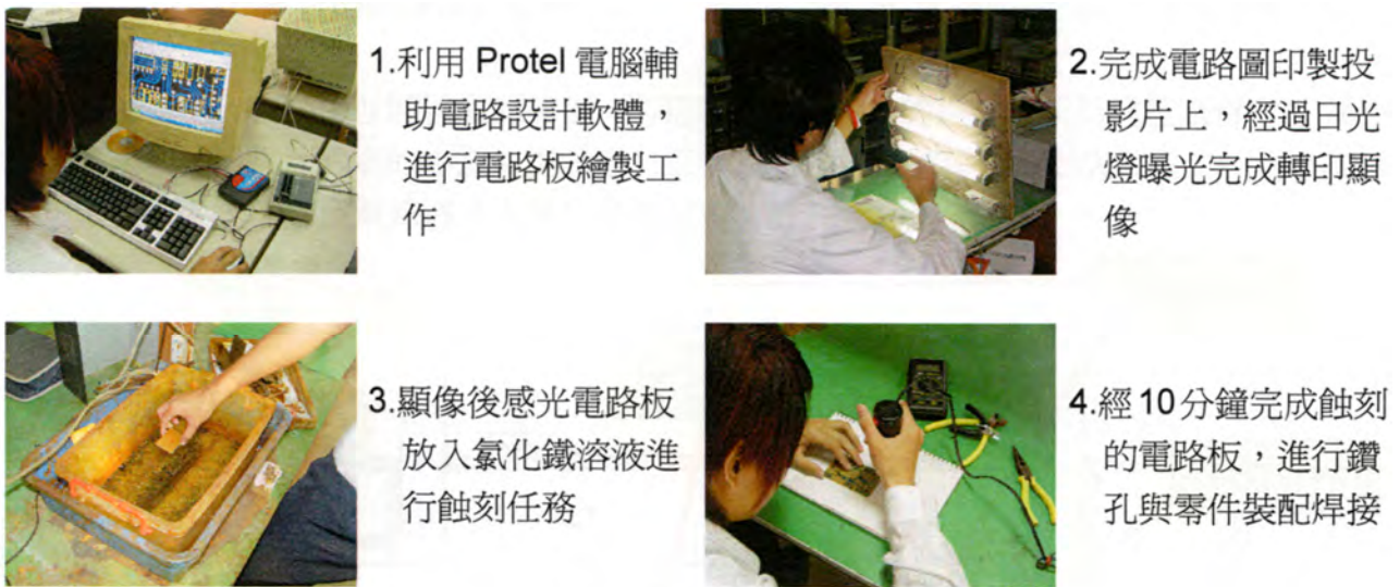
圖 15 電路板製作過程
