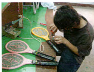
3.拆卸電擊板上重要升壓變壓器與其他元件
