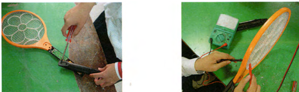
圖 6 測量電蚊拍電擊時所產生電壓狀況
