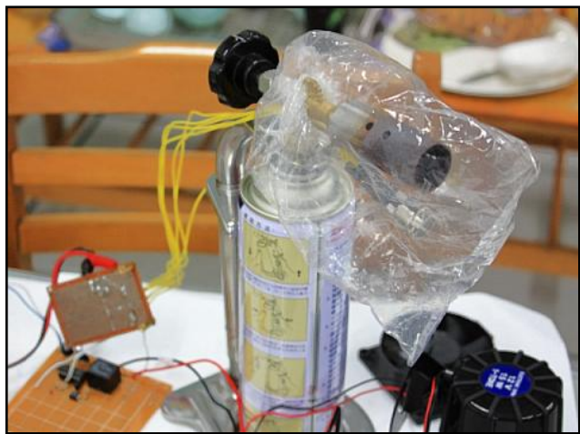
圖二十、利用瓦斯罐測試 CO 感測系統
