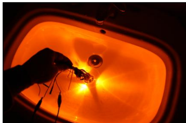
圖二十三、溫度 35^{\circ}\text{C} \sim 45^{\circ}\text{C} ，亮黃光。
