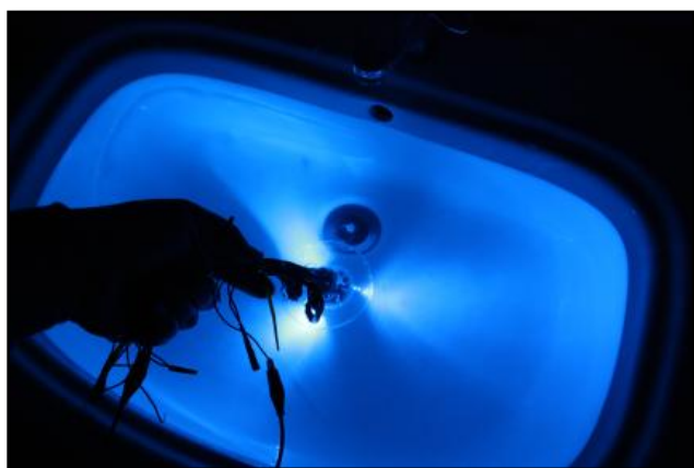
圖二十二、溫度 <35^{\circ}\text{C} ，亮藍光。
