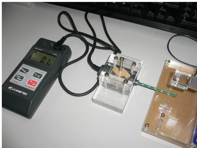
圖 8 磁通密度測量架構
