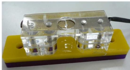
圖 6 鋼珠脫落實驗設計
