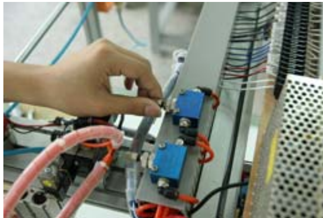
【圖十五 調整節流閥】
