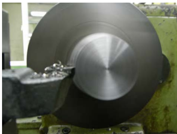
完成精車端面
