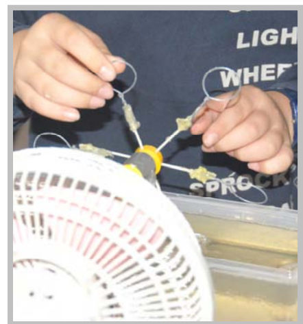
圖 18-3、改變「吹口數量」的實驗過程
