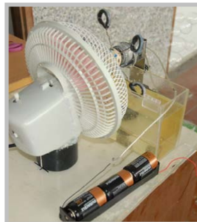
圖 21、三個電池的轉速產生最多泡泡
