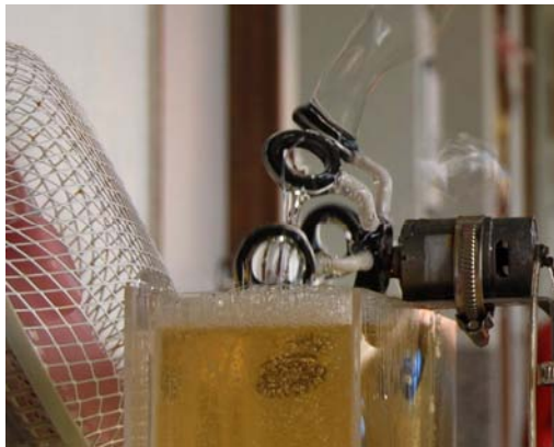
圖22-2、不同吹口角度的實驗過程
