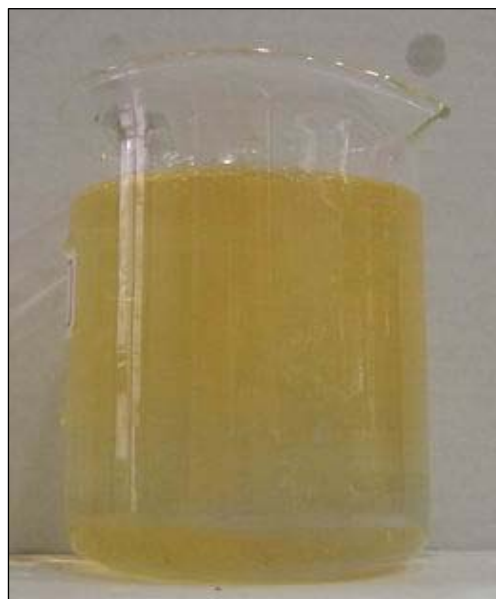
照片4 電解後呈現黃綠色的食鹽水溶液
