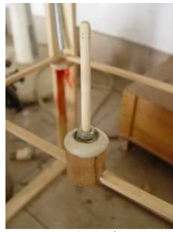
照片 17：架子中心固定圓柱木頭、軸承及竹筷
