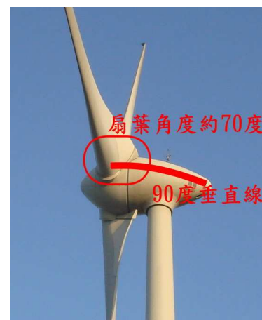
照片 5 風力發電機的扇葉角度
