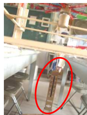
照片 4 利用彈簧秤測量下降 1 公分的受風力
