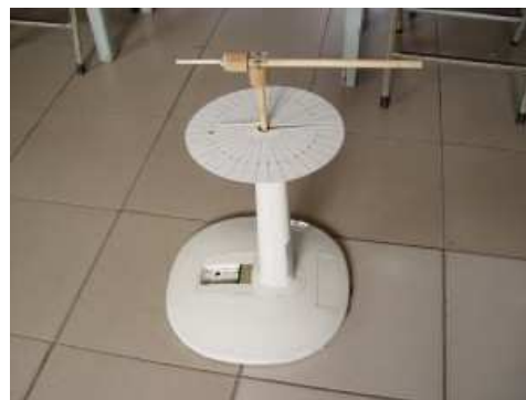
照片 19：隨風轉向實驗支撐架
