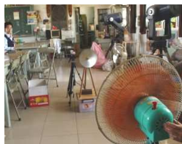
照片 6 風車轉速實驗裝置
