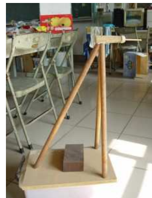
照片 18：風車測速支撐架
