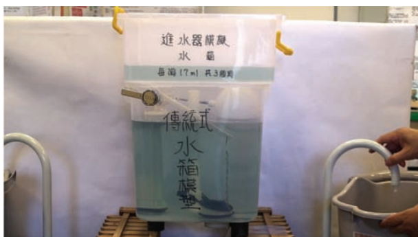
無感漏水實驗
