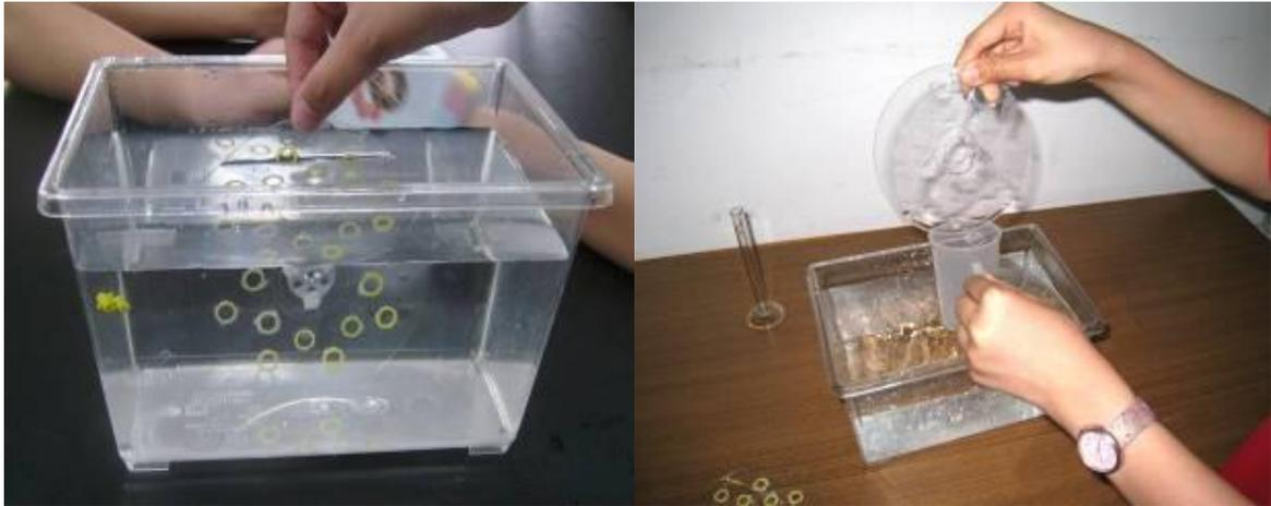
圖八、將光碟浸入水槽中量測吸水量
