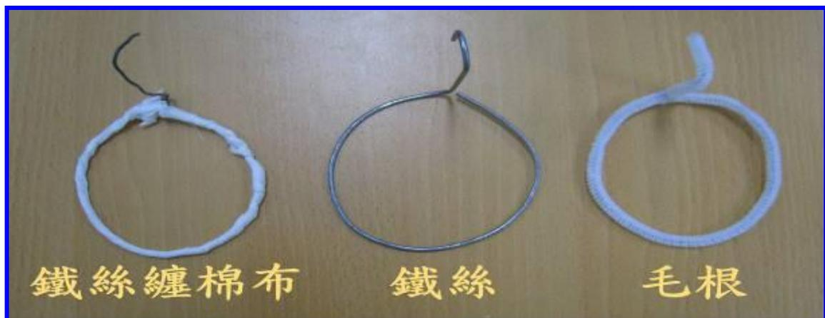
圖二、三種自製鐵絲類發泡圈
