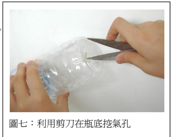
圖七：利用剪刀在瓶底挖氣孔
