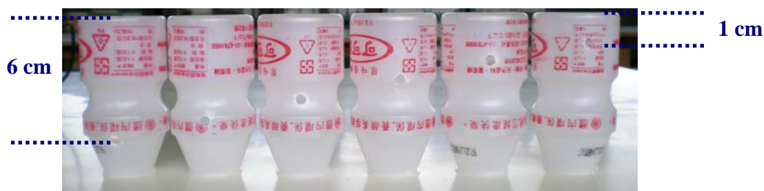
圖 10：垂直方向在不同位置的按孔
