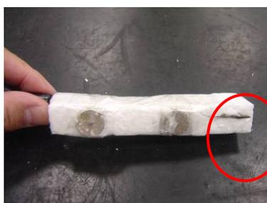
將整隻溫度計包起來，只露出要測量溫度
