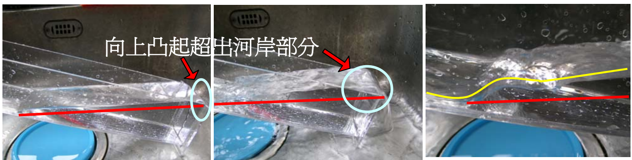
照片二 小流量時下游累積的水面大致呈水平。
