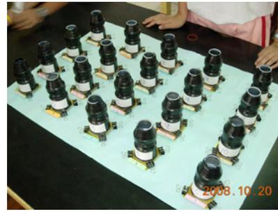
【17】完成 20 支測量器。編號 1 表示 1 張「黃色」透明玻璃紙、編號 2 表示 2 張.... 編號 20 表示 20 張。
