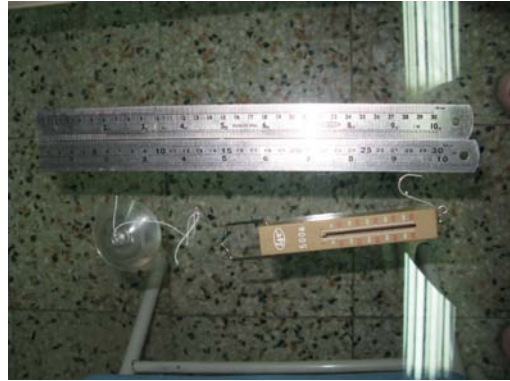
圖 4-15 利用吊秤測量吸盤吸力
