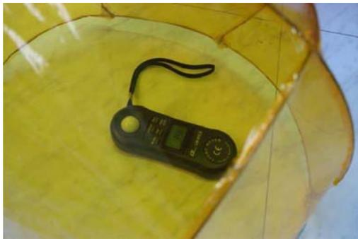
圖 4-36 用照度計測量光罩內量度
