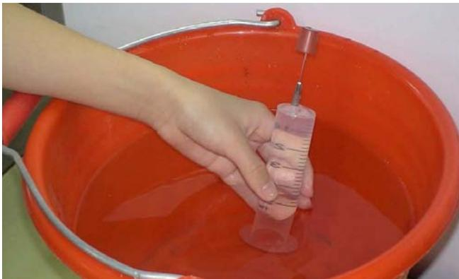
五-4 由薊頭漏斗上方加入鹽酸，剛開始冒出的氣泡不要收集，因為那是過濾瓶內原有的空氣。等大量冒泡時，將橡皮管放入注射筒內收集氫氣，待收滿後再將推桿置入密閉。
