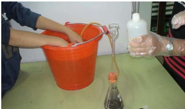
五-8 由薊頭漏斗上方加入雙氧水。等大量冒出氧氣時，一樣用排水集氣法收集。重複操作 五-5、五-6。
