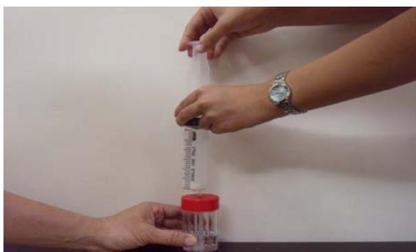
五-12 注射筒內收集滿二氧化碳後，拔起注射筒，再裝上針頭，在玻璃片上打個二氧化碳泡泡並觀察。
