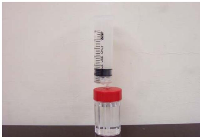
五-11 將推桿向上拉高到極限，讓稀鹽酸充滿針筒內，見大理石冒泡，二氧化碳氣體又將稀鹽酸壓回小罐內。
