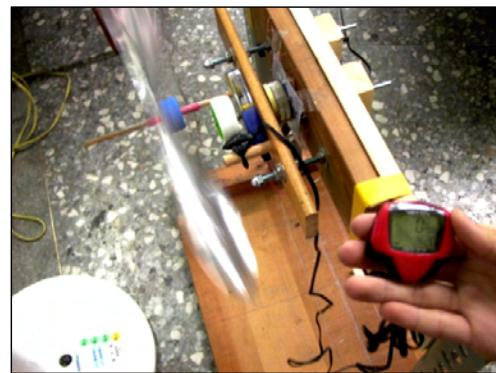
開始測量受風時風扇帶動發電機的平均轉速
