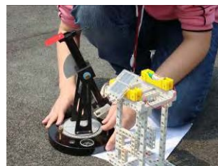
調整太陽能板與太陽 直射的夾角
