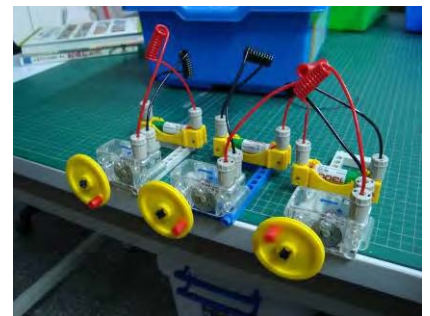
將充飽電的電池連接馬達放電，記錄放電的結果
