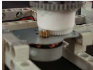
發電機與齒輪組
