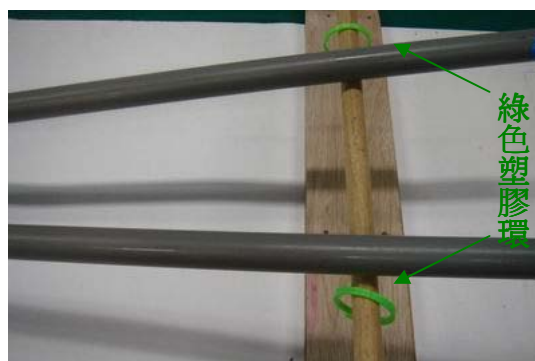
圖 10-3 用綠色塑膠環測量張開最大的軌道角
