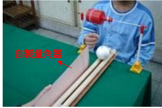
圖 3-2 測量軌道摩擦力的裝置
