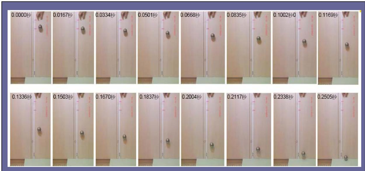
圖九 直徑 6 公分鋼珠空中墜落影像分析 (自 60 公分高處靜止落下)
