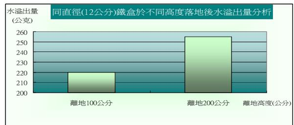
圖二十二 鐵盆內液體溢出量之測量
