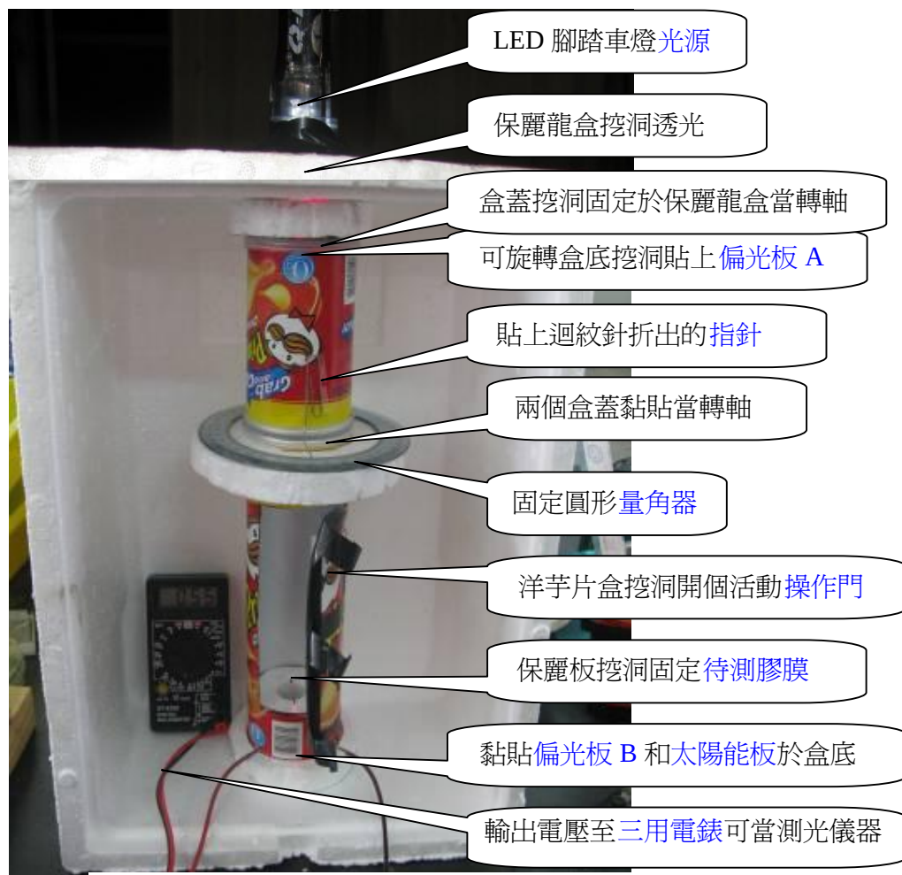
圖十四、簡易旋光儀裝置圖
