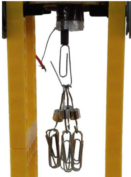
圖 2 砝碼測量磁力示意圖
