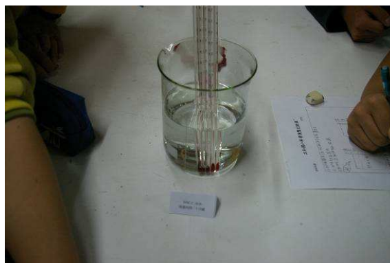
圖 2、以冷水檢驗溫度計
