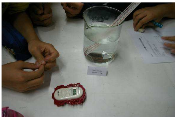
圖 1、以熱水檢驗溫度計
