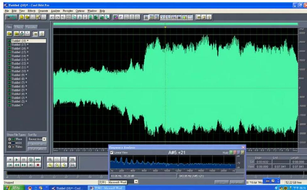
圖 63：同圖 60，黃色虛線處（響度較大）音高為 A#5，顯示響度較大處音高反而較低
