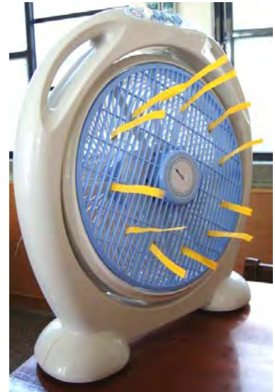
(圖4) 電風扇風向測試
