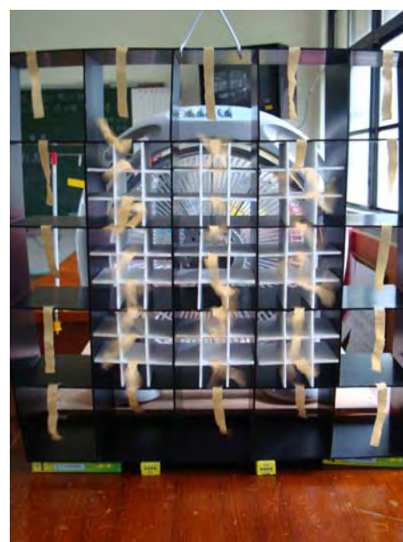
（圖 9）測試加入細格後的導流板
