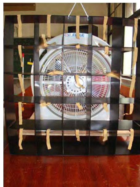
（圖 8）加上導流板後測試風向
