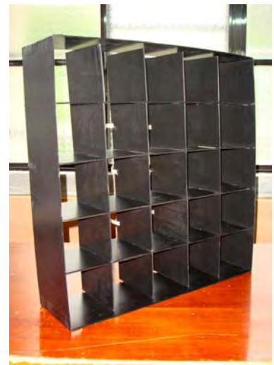
(圖7) 依範例製作的導流板
