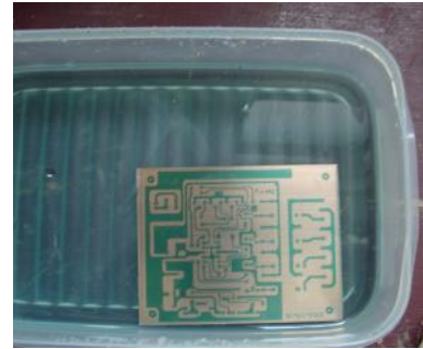
圖4-21 電路板顯影完成
