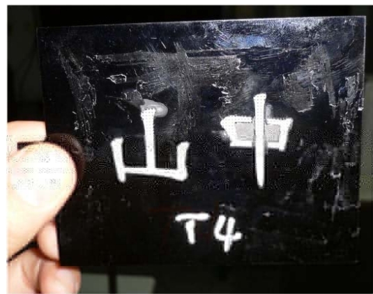
圖 18 半透明材質字體鏤空路標加小孔
