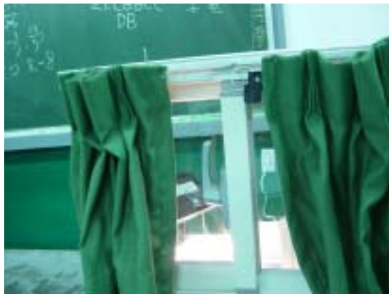
圖 5-3 馬達開啟正轉使窗戶閉闔中
