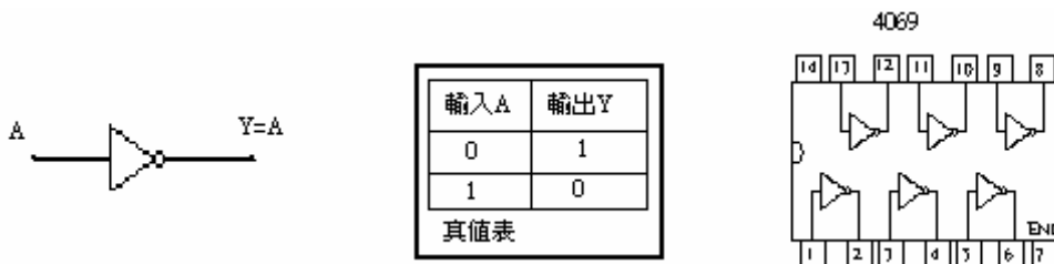
圖4-7 IC4069邏輯圖、真值表、IC腳位
