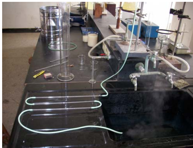
改採玻璃管做冷凝器
