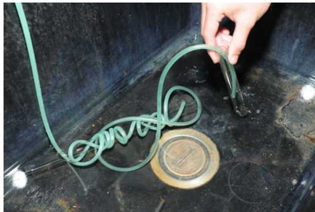
把矽膠管纏繞成螺旋狀放入水槽中充當冷凝器並在水槽中放入大量的水
