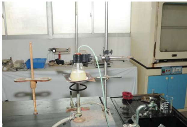
第一代蒸餾設備：使用錐型瓶、矽膠管、溫度計
