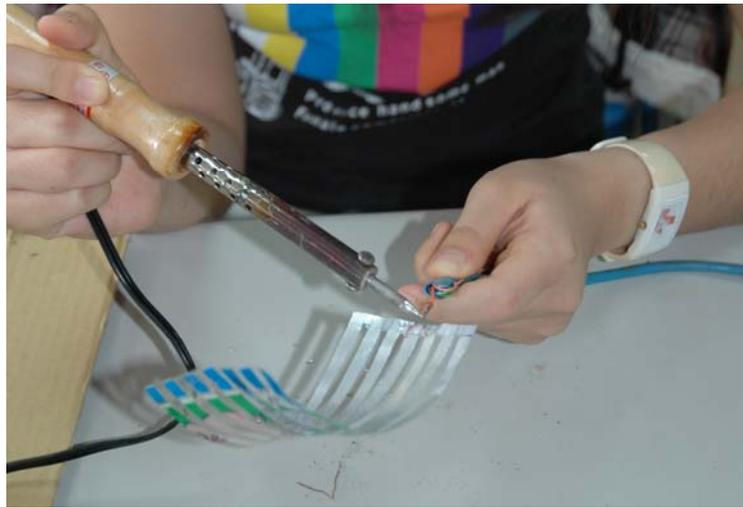
圖 6-14，使用銲槍將鋁片與電線連接
