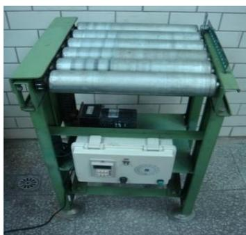
圖 4-1 改良式自製滾動研磨機
