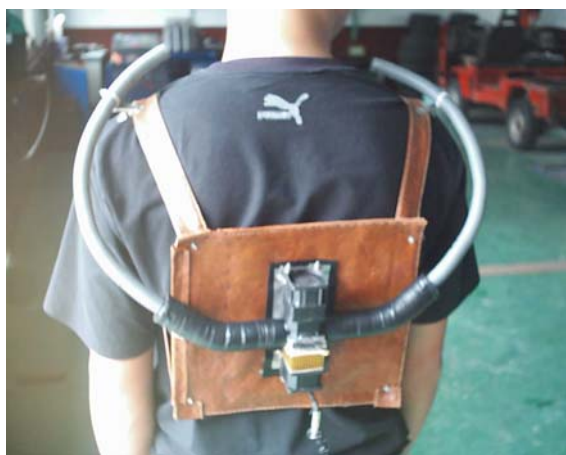
圖 1、2. 第一代冷氣背心出風口為二條風管設計，且騎士必須背著上路。
