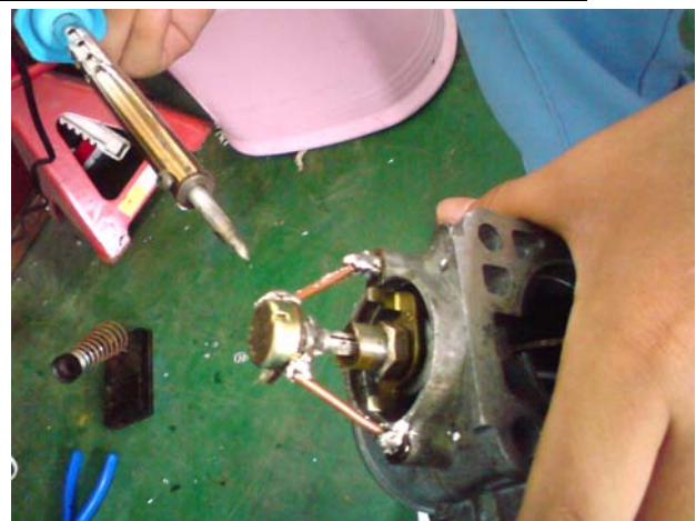
圖 12. 使用烙鐵將電阻焊在節汽門軸上
