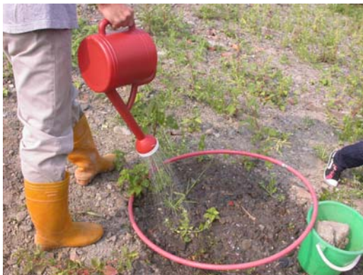
照片 3 用澆水器灑水，模擬降雨
