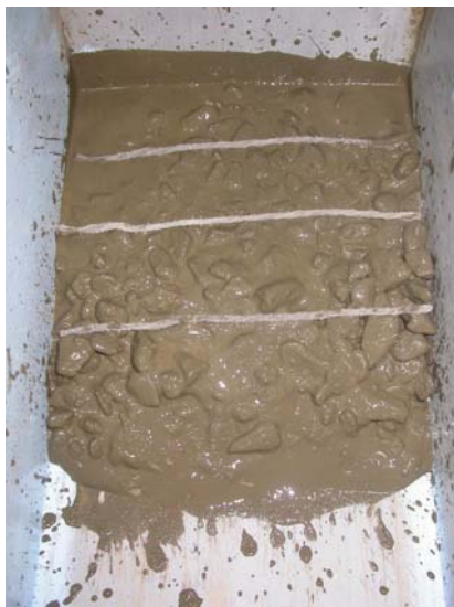
照片 11 實驗前在土石上放置三條平行棉線
