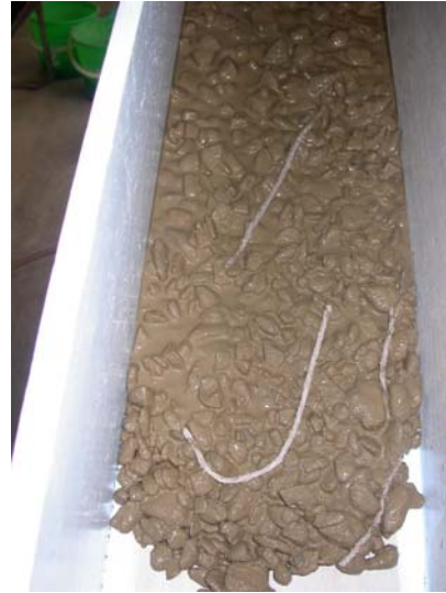
照片 14 土石運動後三條線明 顯彎曲則為流動
