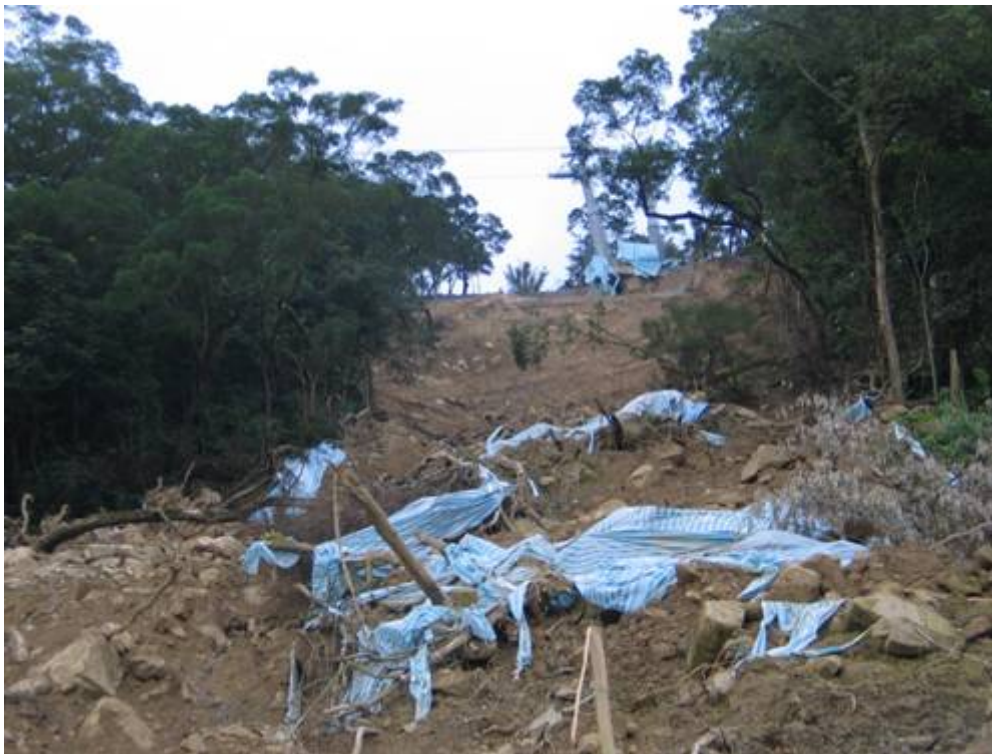
圖七 現場取樣是依照地層滑動邊坡之上段、中段及下段逐一取樣。
