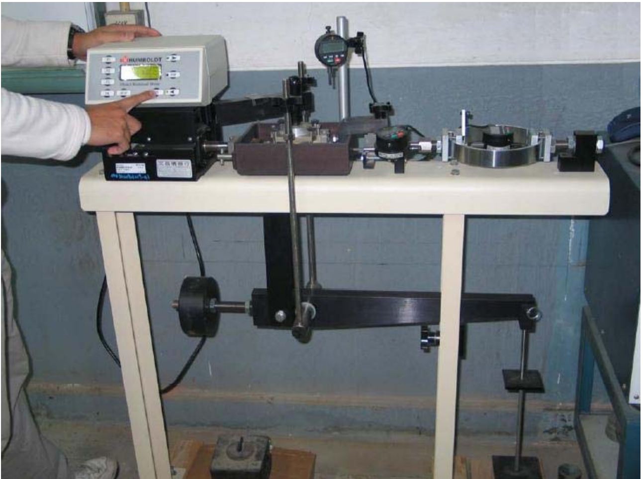
圖九 直接剪力試驗儀是用來量測地表土壤之力學強度。
