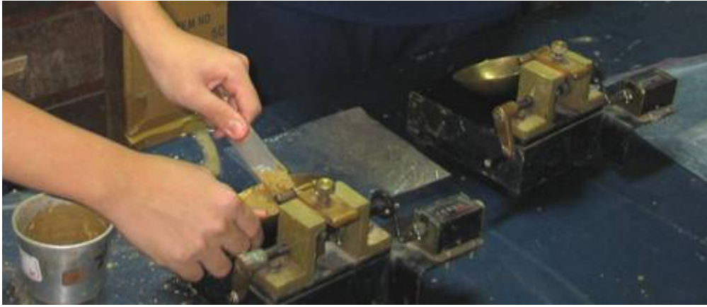
圖八 阿太堡儀器為量測液性限度。
