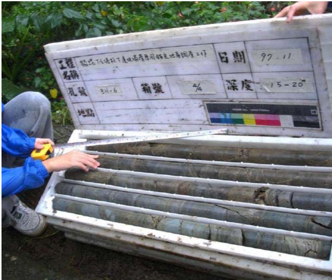
圖六 現場鑽探岩心可以輔助估算岩石品質指標，找出岩層的破碎帶。
