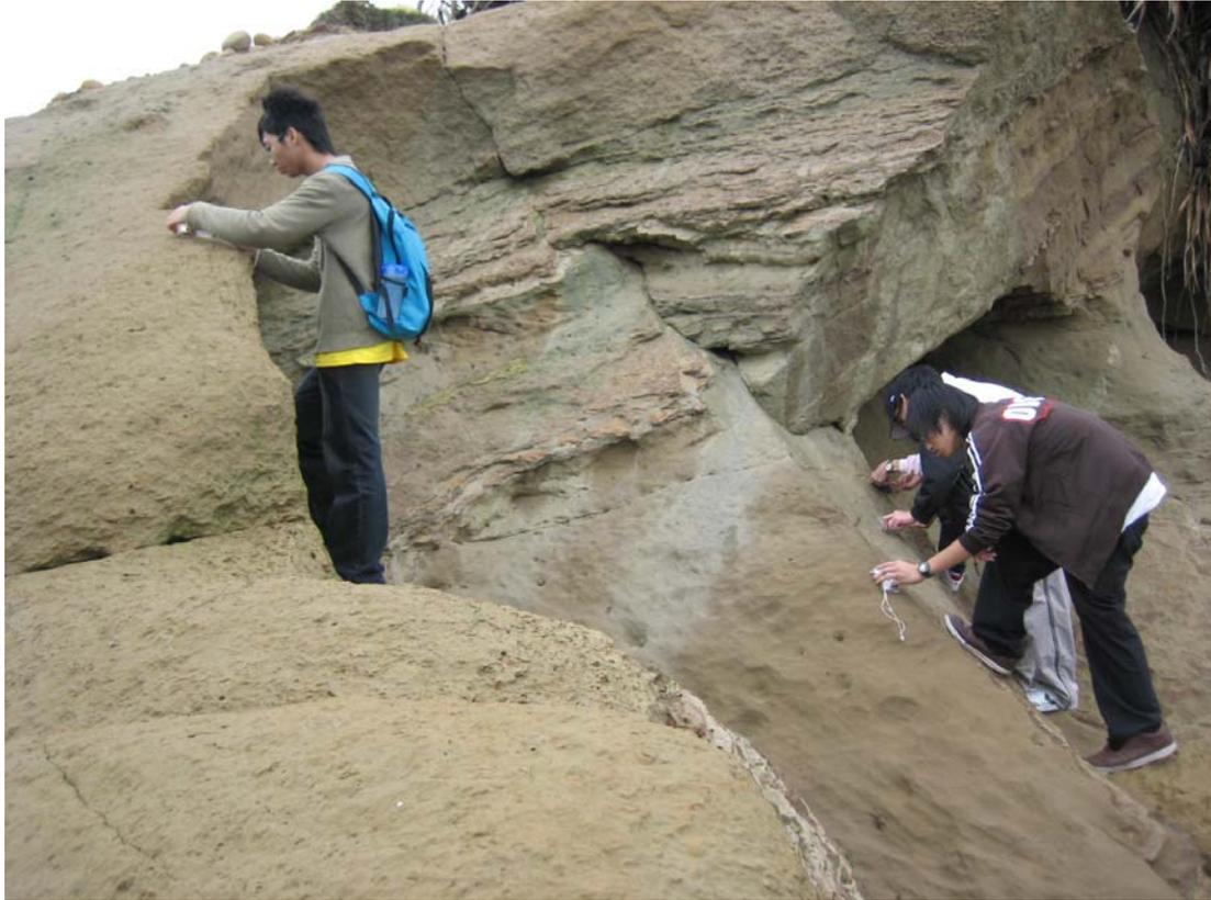
照片一 於苗栗龍港使用傾斜儀測量地層的走向與傾斜。
