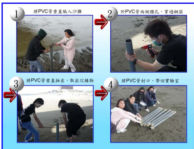
圖 4-7 步驟一：野外沉積物採樣流程圖
