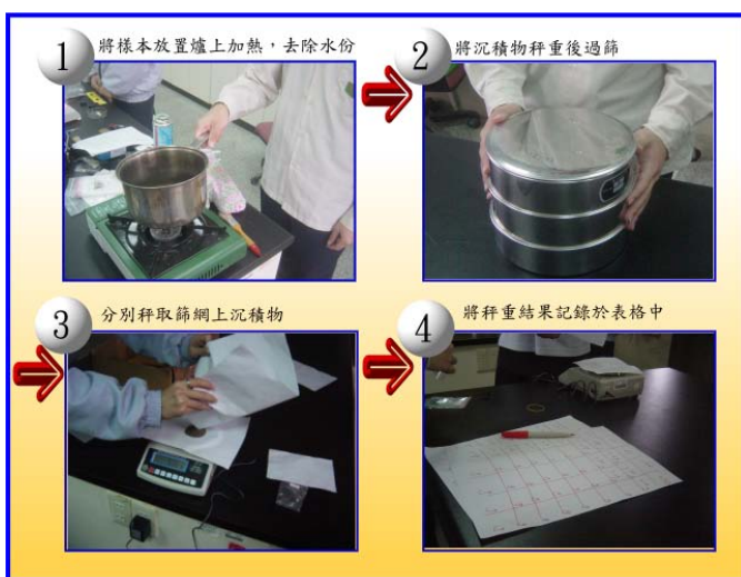
圖 4-9 步驟三：沉積物分層粒度分析流程圖
