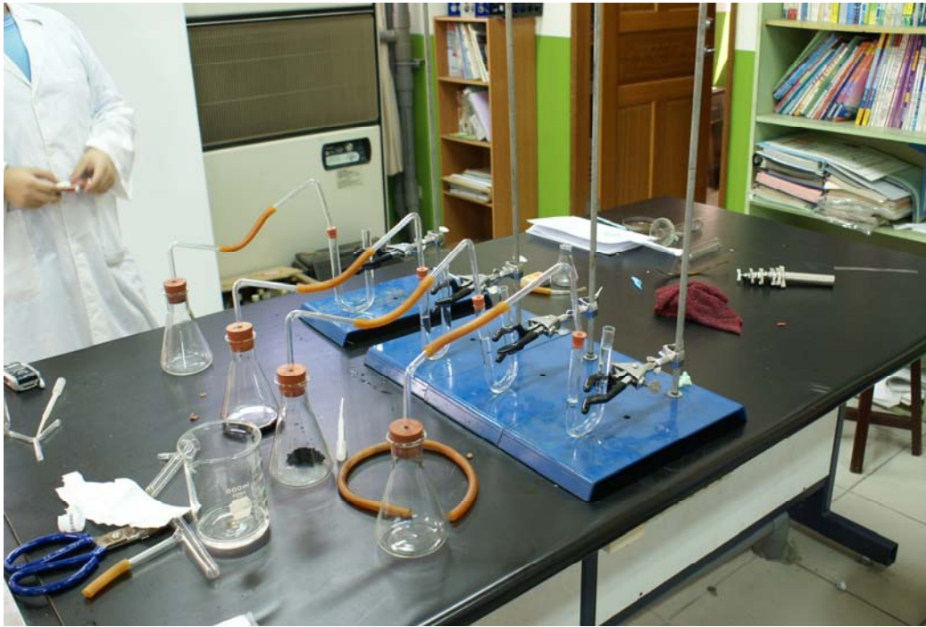
圖 5 測試各種試劑吸收乙烯的能力
