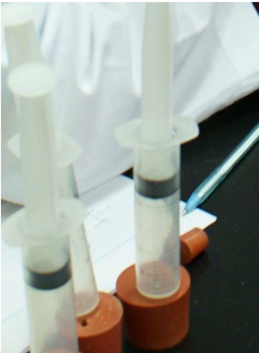
圖 3 製好的乙烯插在有洞的橡皮塞上備用
