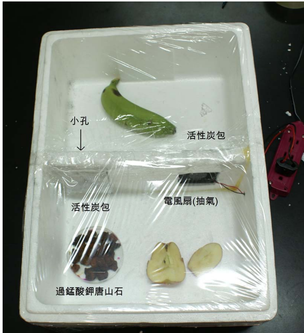
圖 11 自製實驗箱搭配自製乙烯吸收劑實驗情形
