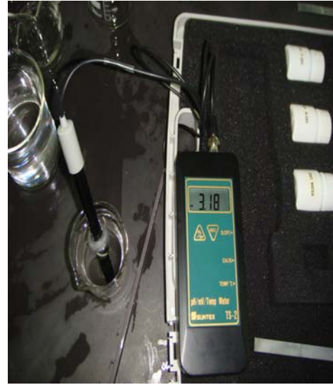
圖 3-2 量測電解液 pH 值變化
