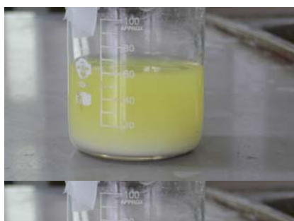
A 廢水加入黃血鹽水溶液後 2\text{Zn}^{2+} + \text{Fe}(\text{CN})_6^{4-} \rightarrow \text{Zn}_2\text{Fe}(\text{CN})_6 乳白色
