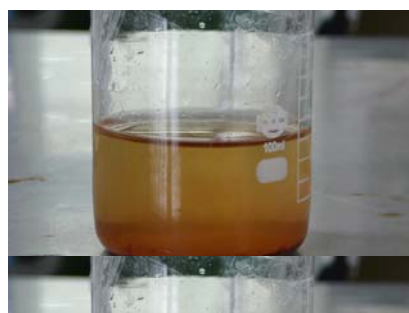
C 廢水加入黃血鹽水溶液後 2\text{Cu}^{2+} + \text{Fe}(\text{CN})_6^{4-} \rightarrow \text{Cu}_2\text{Fe}(\text{CN})_6 紅棕色
